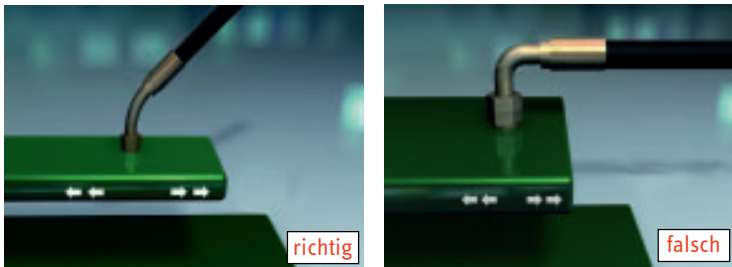
Abbildung 15: Verlegung bei Schwingungen
