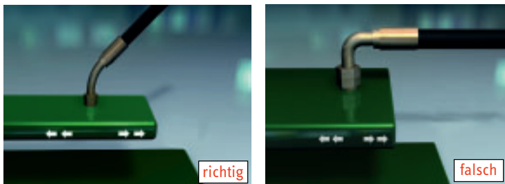
Abbildung 15: Verlegung bei Schwingungen
