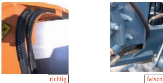
Abbildung 10: Vermeidung von Abknicken oder Scheuern
