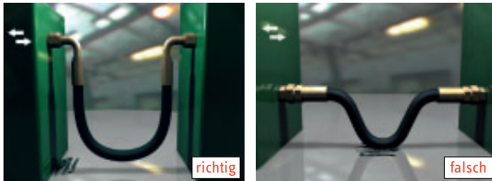
Abbildung 9: Vermeidung von Abrieb durch ausreichende Bewegungsfreiheit
